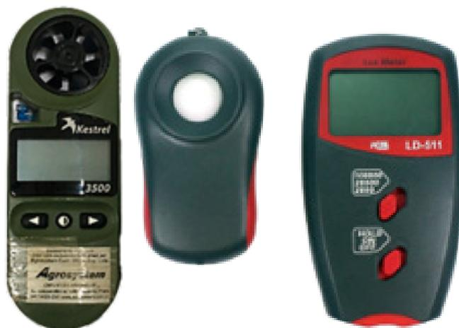
**Figura 3** – Medidor de multiparâmetros<sup>1</sup> e luxímetro<sup>2</sup>, respectivamente. Fonte: primária.
