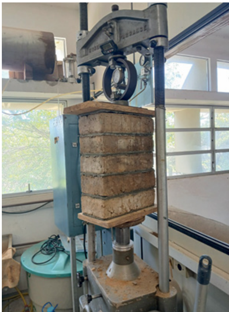
Figura 12 – Compressão do prisma
