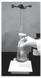
Figura 4 - Titulação do tiossulfato de sódio (0,1N) sob agitação
