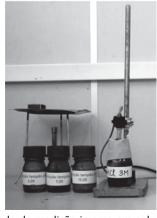
Figura 6 – Eletrodo de medição imerso em solução de cloreto de potássio 3 molar e soluções-tampão pH 4,00, pH 7,00 e pH 10,00
